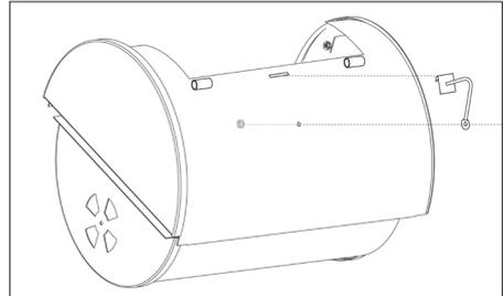
17. Befestigen Sie die kleine Brennkammer am Halteblech (**14**) und an der großen Brennkammer mit 8 Stück Schrauben M6 x 12mm und 2 Stück Muttern M6.
