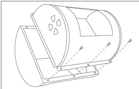
15. Die Luftklappe für die kleine Brennkammer (**24**) in der Brennkammer mit einer Schraube M6 x 12mm und einer Mutter M6 befestigen.
