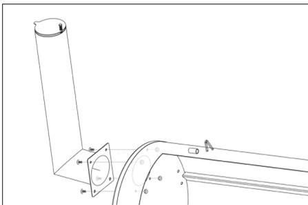
10. Den Fettdosenhalter (23) von unten durch das Loch auf der linken Seite in die große Brennkammer stecken.
