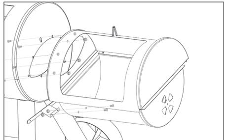
18. Das Halteblech für den Aschekasten (**13**) an der kleinen Brennkammer mit 6 Stück Schrauben M6 x 12mm und 6 Stück Muttern M6 befestigen. Den Aschekasten (**20**) in die Schienen des Halteblechs schieben.
