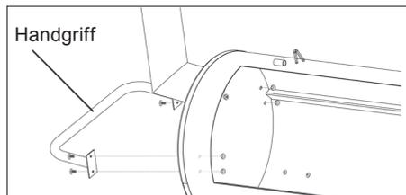
13. Das Halteblech (**14**) für die kleine Brennkammer an den Stützbeinen mit den Rädern mit 2 Stück Schrauben M6 x 12mm befestigen.
