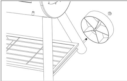
8. Die Abluftklappe (9) über den Schraubstutzen oberhalb des Rauchrohres (7) setzen. Anschließend die Feder (8) auf den Schraubstutzen setzen und mit Hutmutter festziehen.
