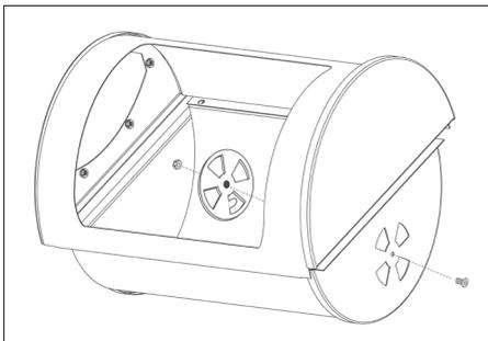
16. Den Deckelstopper für die kleine Brennkammer (**25**) mit einer Schraube M6 x 12mm und einer Mutter M6 befestigen.
