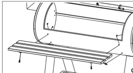
12. Den Handgriff (10) mit 4 Stück Schrauben M6 x 12mm und 4 Stück Muttern M6 an der großen Brennkammer befestigen.
