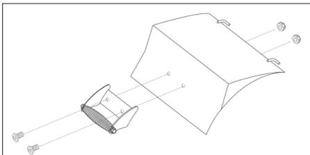
22. Die Deckel an der kleinen und großen Brennkammer befestigen. Hierzu die Scharnierstifte in die Scharniere schieben und mit den 4 Stück Scharnierschrauben befestigen.
