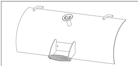
21. Verbinden Sie den Handgriff (26) mit dem Deckel der kleinen Brennkammer mit den mitgelieferten 2 Stück Schrauben und 2 Stück Muttern.
