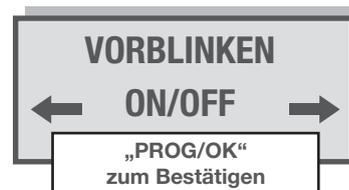
Definiert die Funktion der an Klemme 13-LP -angeschlossenen Blinkleuchte.
