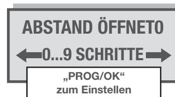
*Definiert die Dauer bis zur automatischen Schließung nach kompletter Öffnung. Die AUTO WIEDERSCHLIEßUNG muss auf Seite 11 unter dem Punkt 6.1 „OPTI-ONEN“ zum Aktivieren auf ON gestellt werden.*
