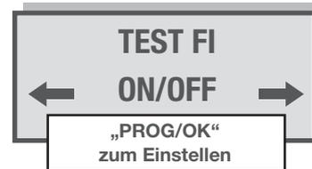
Aktiviert die Überwachung der an Klemme 9-FS -angeschlossenen Sicherheitseinrichtung.
