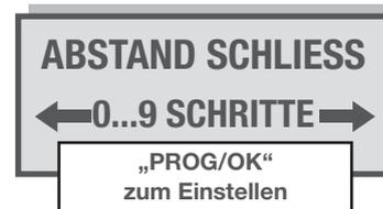
*Definiert die Annäherung des Flügels an den Haltepfosten bei der Öffnung.*
