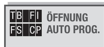
Das Tor schließt selbstständig bis zum internen Anschlag, überprüft diesen auch ein zweites Mal und speichert ihn ab.
