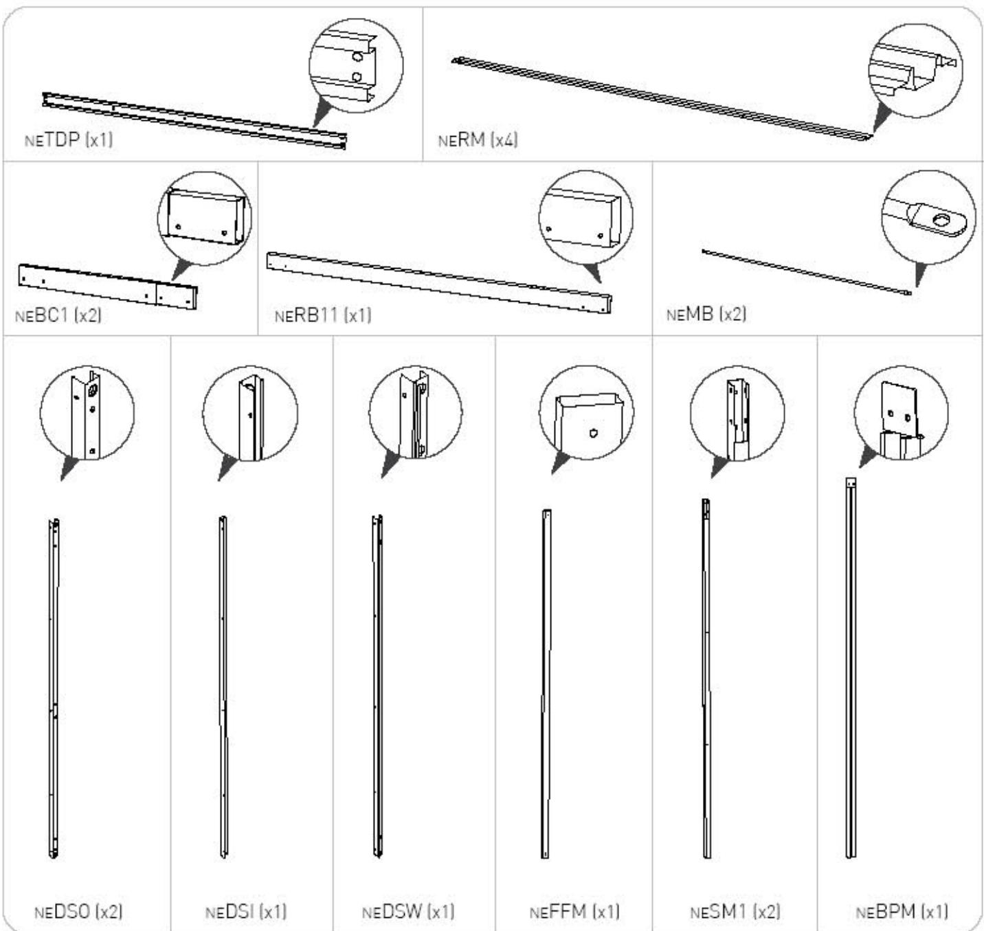
WINDOW PARTS | PIÈCES DE LA FENÊTRE | PARTES DE LA VENTANA | FENSTERELEMENTE | VENSTERONDERDELEN | PARTI DELLA FINESTRA | PEÇAS DA JANELA
