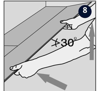
8 Heben Sie die Dielen (zusammen mit der vorher gelegten Dielen in der gleichen Reihe) etwa 30 mm an der Vorderkante an und drücken Sie diese in die Dielenreihe hinein. Wenn die Längskanten aufeinander stoßen, legen Sie die Dielen auf den Boden.
