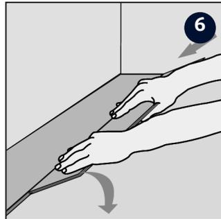
6 Drücken Sie die Längsseite der ersten Dielen der zweiten Reihe im Winkel gegen die davor liegende Dielen. Pressen Sie die Dielen weiter nach vorne und legen Sie sie gleichzeitig an den Boden an.
