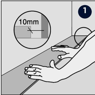
1 Legen Sie das erste Element entlang der Wand aus. Dabei werden die Federseiten gegen die Wand gelegt. Achten Sie darauf, dass Sie ca. 10 mm Abstand zwischen der Stirnseite der Dielen und der Wand haben. Der Abstand der Längsseite von der Wand (ca. 10 mm) kann später festgelegt werden, wenn drei Reihen verlegt worden sind.
