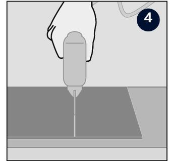
4 Sägen Sie die Länge zu, am besten mit Hilfe einer Stichsäge. Legen Sie die Dielen mit der Dekorseite auf die Sägeunterlage. Als Alternative kann eine feingezahnte Handsäge benutzt werden, aber dann muss die Dekorseite nach oben zeigen.
