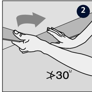
2 Drücken Sie die nächste Bodendiele im Winkel an die erste Dielen und drücken Sie anschließend die Dielen auf den Boden. Verfahren Sie in der gleichen Weise mit der gesamten ersten Reihe.
