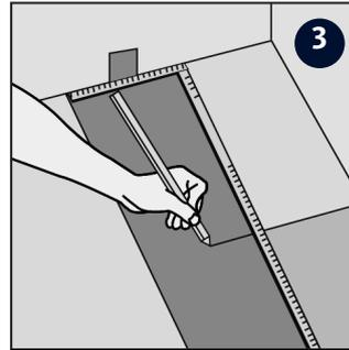
3 Legen Sie die letzte Dielen mit der Unterseite nach oben, die Stirnseite ohne Verriegelungsleiste der Wand zugewandt. Der Abstand zur Wand soll ca. 10 mm betragen. Markieren Sie die Stelle, an der die Dielen abgesägt werden soll.
