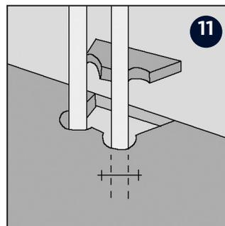
11 Bohren Sie entsprechende Löcher in die Dielen. Die Bohrungen sollten 20 mm größer im Durchmesser sein als die Rohre. Setzen Sie das ausgesägte Stück mit Leim wieder ein. Decken Sie die Fuge anschließend mit einer Heizkörperrosette ab.
