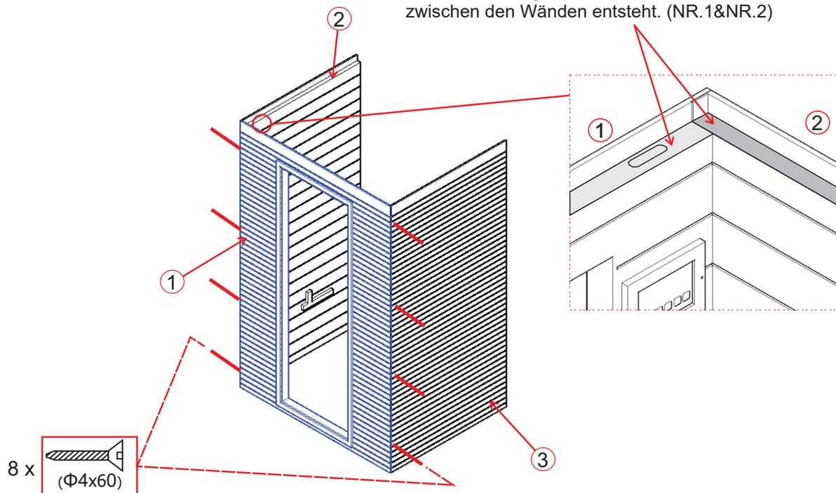
Achten Sie darauf, dass beim Verbinden der Seiten mit dem Rücken alle Wände auf gleichem Niveau stehen bzw. kein Höhenversatz zwischen den Wänden entsteht (NR.2&NR.4)
