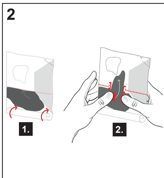
**DE** Klebstoffkammer umfalten und den Klebstoff in Richtung der schmalen Reaktionskammer drücken, bis die Trennaht aufplatzt.
