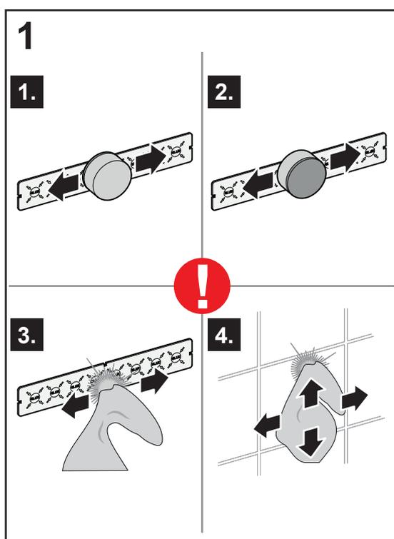
**DE** Klebefläche der Montageplatte mit dem Schleifvlies anschleifen und anschließend Montageplatte und Fliesenfläche gründlich mit dem Reinigungstuch i.CLEANER reinigen.
