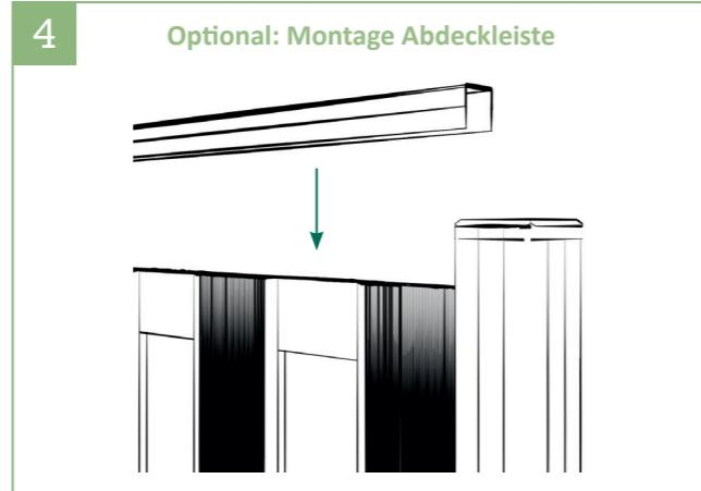
4 | Die Abdeckleiste von oben auf das Element setzen.
