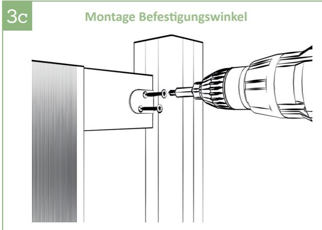
3c | Die Befestigungswinkel werden von hinten mittig an dem Aluminiumquerriegel befestigt. Die Schraublöcher mit einem 3 mm Bohrer vorbohren!
