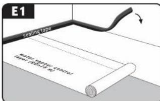
**Achtung:** Es ist unbedingt erforderlich, die systembezogene Feuchteschutzfolie vollflächig zu verlegen und mit einem Abdichtungstape im Wandanschlussbereich wannenförmig abzudichten.
