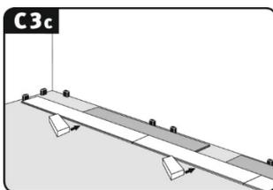
**Achtung!** Nach längsseitiger Verriegelung der Elemente mit einem geeigneten Schlagklotz nachklopfen, um eine vollständige Verriegelung zu gewährleisten.
