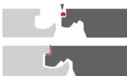
In gewerblichen Bereichen, in denen mit einer überdurchschnittlichen Beanspruchung mit Feuchtigkeit/Flüssigkeit zu rechnen ist, wird eine Versiegelungsverleimung mit PVAC Leim (D3) notwendig. Den Versiegelungsleim so auf die stirn- und längsseitige Feder auftragen, dass dieser beim Zusammenfügen der Elemente über die gesamte Länge der Verbindung nach oben austritt. Überschüssiger Versiegelungsleim kann sofort oder nach kurzem Antrocknen von der Oberfläche entfernt werden.
