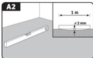
Die Prüfung der Ebenheit orientiert sich an der gängigen Normung und erfolgt durch Auflegen einer Messlatte/Richtscheit auf den Hochpunkten der Fläche und Ermittlung des Stichmaßes an der tiefsten Stelle in Bezug zu den Auflageflächen (Messpunktabständen). Bei einem Messpunktabstand von 100 cm darf eine vertikale Abweichung von maximal 2 mm vorliegen. Größere Abweichungen sind durch entsprechende Maßnahmen (z. B. durch selbstverlaufende Spachtelmassen) auszugleichen.
