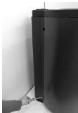
**Fig. 64 - Die seitlichen Schrauben lösen**
