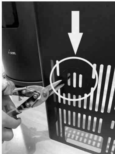
Fig. 51 - Ring zerschneiden
