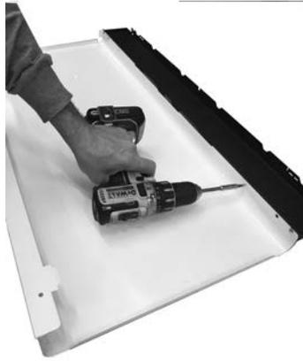
Fig. 35 - Die farbige Seitenwand befestigen
