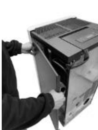
Fig. 29 - Die Seitenwände aushaken
