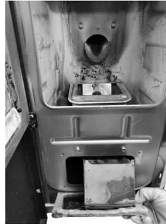
*Fig. 68 - Den Inspektionsstopfen entfernen*
