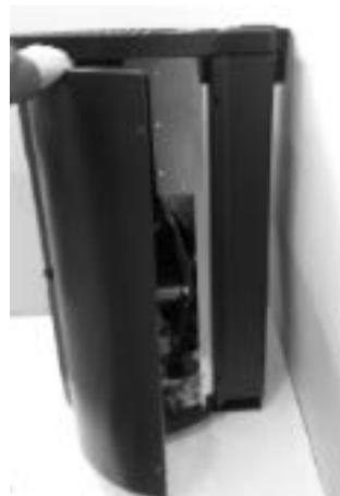
*Fig. 44 - Die Seitenwände aushaken*
