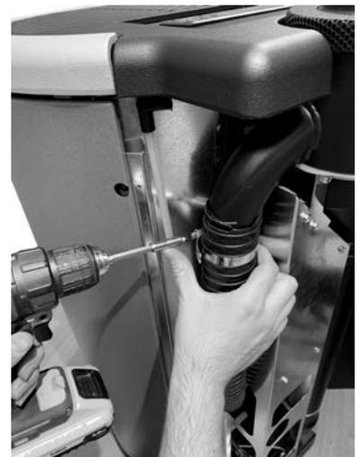
Fig. 52 - Schlauch herausziehen
