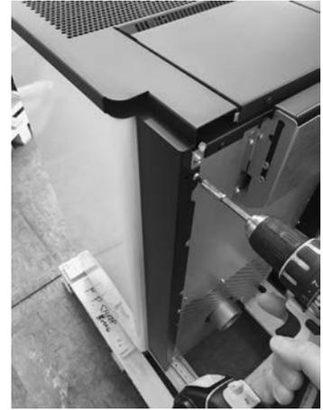
Fig. 36 - Die vollständige Seitenwand befestigen
