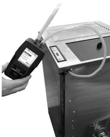
Fig. 61 - Anschluss des Digitaldruckwächters
