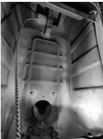
*Fig. 71 - Mit einer Rohrreinigungsbürste reinigen*
