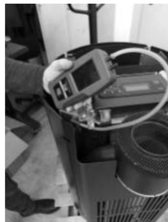
Fig. 62 - Anschluss des Digitaldruckwächters
