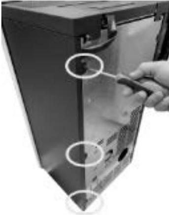
Fig. 28 - Die Schrauben entfernen
