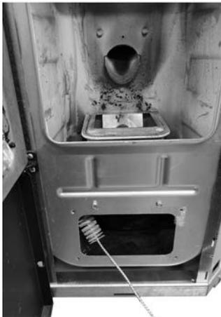
*Fig. 69 - Mit einer Rohrreinigungsbürste reinigen*
