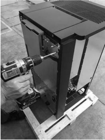
Fig. 34 - Das schwarze Profil entfernen
