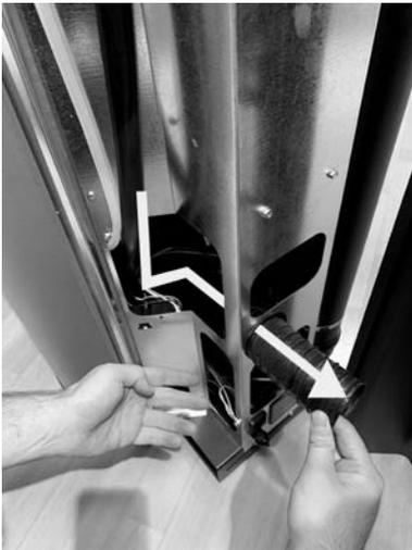
Fig. 53 - Einschieben des Schlauchs 1
