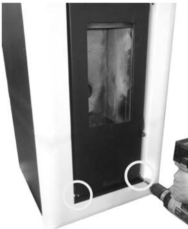
*Fig. 25 - Die Schrauben entfernen*
