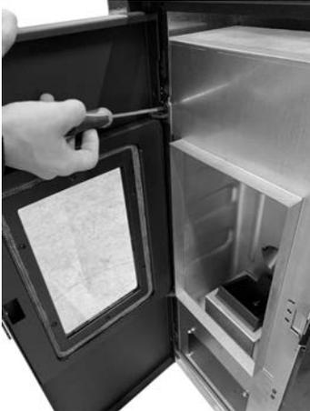
*Fig. 22 - Die Schrauben abnehmen*
