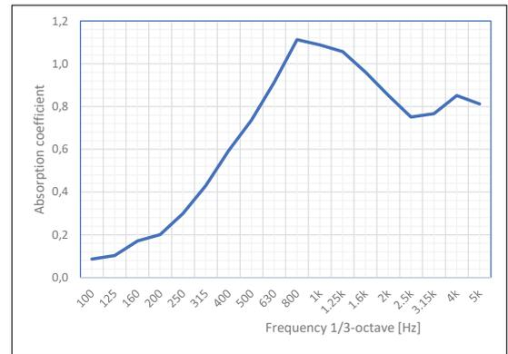
Die 11 Platten wurden im Hallraum flach auf dem Betonboden ausgelegt. Geschlossener Rahmen um die Kanten.
