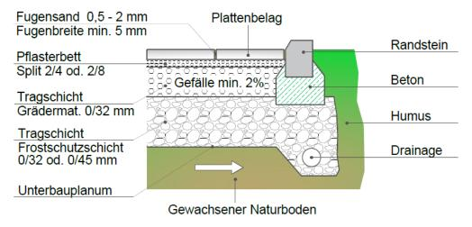
Für einen stabilen, frostsicheren und wasserdurchlässigen Oberbau des Pflasters ist, je nach anstehendem Boden und zu erwartender Belastung ein Aushub von 30 bis 60 cm einzuplanen. Damit die Wegkanten später nicht einsinken, sollte der Oberbau zudem beidseitig jeweils 15 cm breiter als die geplante Pflasterfläche angelegt werden.
