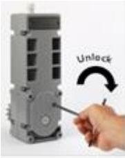
Der Getriebemotor ist mit einer mechanischen Entriegelung ausgerüstet, die mit einem Sechskantschlüssel betätigt wird.
