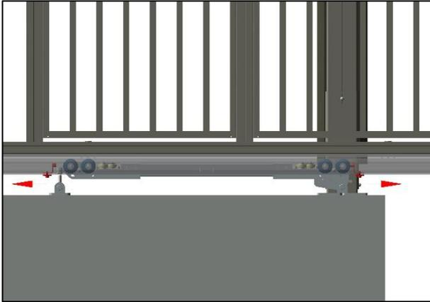
Abbildung 9: Endanschläge verschieben
