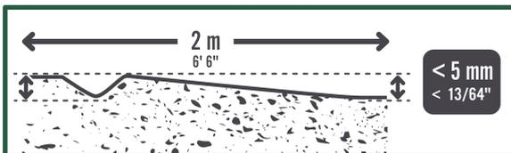
La planéité doit être < à 5 mm sous la règle de 2 mètres.
