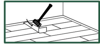
La dernière rangée s'assemble à l'aide d'un tire-lame et un maillet anti-rebond.
