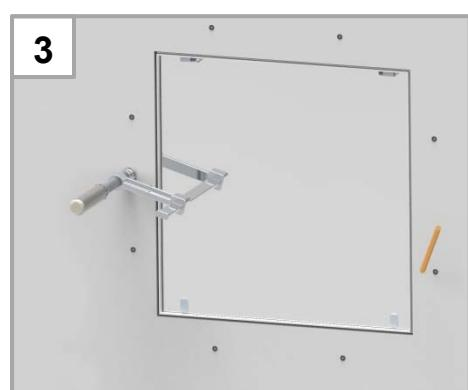
Rahmen ausrichten (Rechtwinkligkeit prüfen), festspannen und Bohrungen
