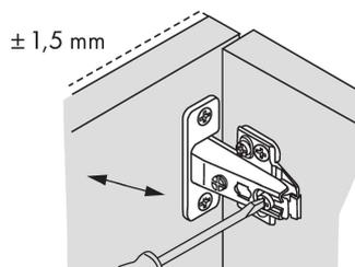
Alle Möbelscharniere können in der Tiefe um  $\pm 1,5 \text{ mm}$  über eine Fixierschraube im Bandarm verstellt werden. Je nach Ausführung kann auch an der Montageplatte diese Verstellung über einen Excenter vorgenommen werden.
