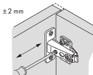
Alle Möbelscharniere können seitlich um  $\pm 2 \text{ mm}$  über eine Stellschraube im Bandarm verstellt werden.
