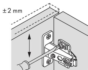
Alle Montageplatten können in der Höhe um  $\pm 2 \text{ mm}$  über ein Langloch, internes Verschieben oder über Excenter verstellt werden.
