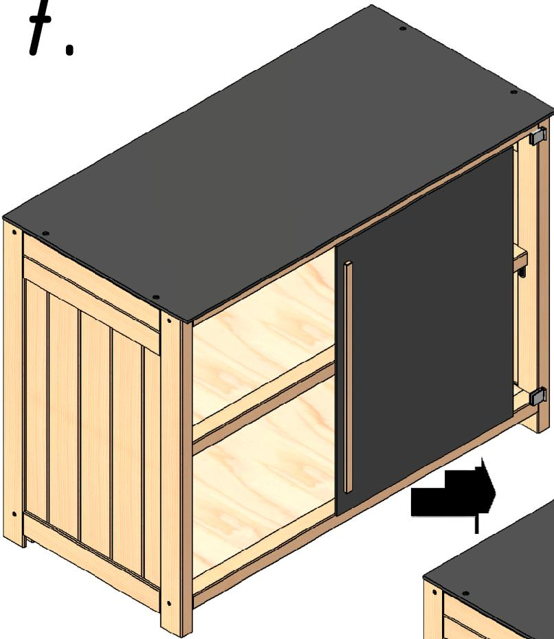
HPL-Türen (B) in die Klemmscharniere (5) schieben und mit der Klemmschraube im Scharnier fixieren!
