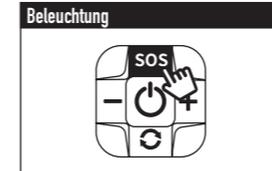
Durch Drücken der SOS-Taste geht das weiße Licht an. Durch erneutes Drücken wechselt die Lampe auf rotes Blinken (Blinkintervall 1 Sek). Durch ein weiteres Drücken wechselt das Blinken auf schnelles rotes Blinken (Blinkintervall 0,5 Sek). Drücken Sie das Licht erneut, um das Licht auszuschalten.
