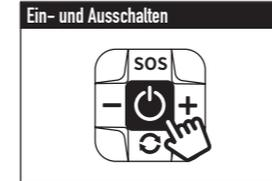
Drücken Sie den Schalter 3 Sekunden lang um das Gerät ein- und auszuschalten. Wenn im eingeschalteten Zustand innerhalb von 3 Minuten keine Bedienung erfolgt, schaltet das Gerät sich automatisch ab. Um den Kompressor einzuschalten, drücken Sie erneut auf die Taste. Um den Kompressor auszuschalten drücken Sie kurz auf die Taste.
