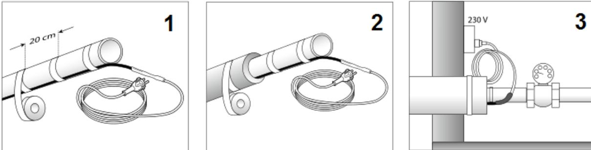
Wanneer de kabel te lang is, of u wenst meer vermogen, dan mag de kabel ook spiraalvormig om de leiding gewikkeld worden. Dat de kabel zichzelf ergens kruist is geen probleem, hij zal niet oververhitten.
