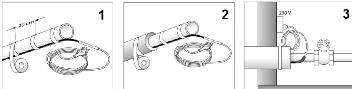
Je-li kabel příliš dlouhý, nebo jestliže si přejete vyšší výkon, můžete kabel také omotat kolem kabelu ve tvaru spirály. Jestliže se kabel překřížuje, není to problém. Kabel se nebude přehřívat.
