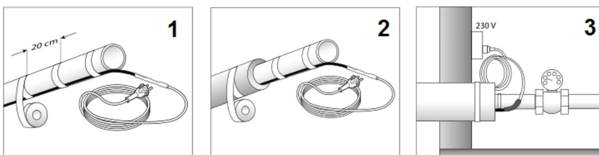
Lorsque le câble est trop long, ou lorsque vous voulez plus de puissance, vous pouvez aussi envelopper le câble en spirale autour du tuyau. Que le câble se chevauche à un quelconque endroit n'est pas un problème, il ne surchauffera pas.
