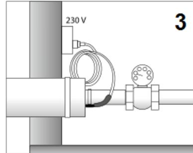
Wenn das Kabel zu lang ist, oder wenn Sie mehr Leistung benötigen, kann das Kabel auch spiralförmig um die Leitung gewickelt werden. Es ist kein Problem, wenn das Kabel sich an bestimmten Stellen selbst kreuzt, es wird sich nicht überhitzen.
