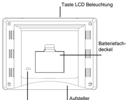
**Micro USB Anschluss für Netzteil:
