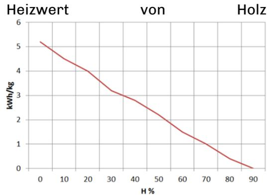
Abbildung 2 Beziehung zwischen Feuchtigkeit und Heizwert von Holz
