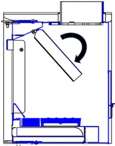
*Abbildung 7 Drehen und Entfernen des oberen Stahlabweisers*
