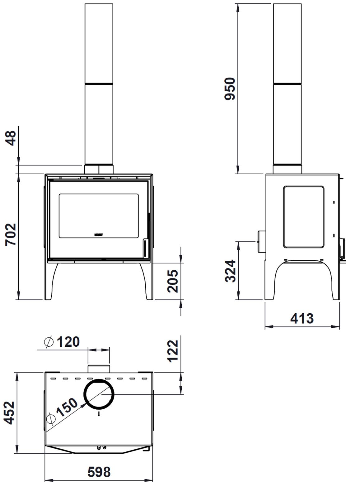
Abbildung 1 Abmessungen des Geräts in mm ARGOS
