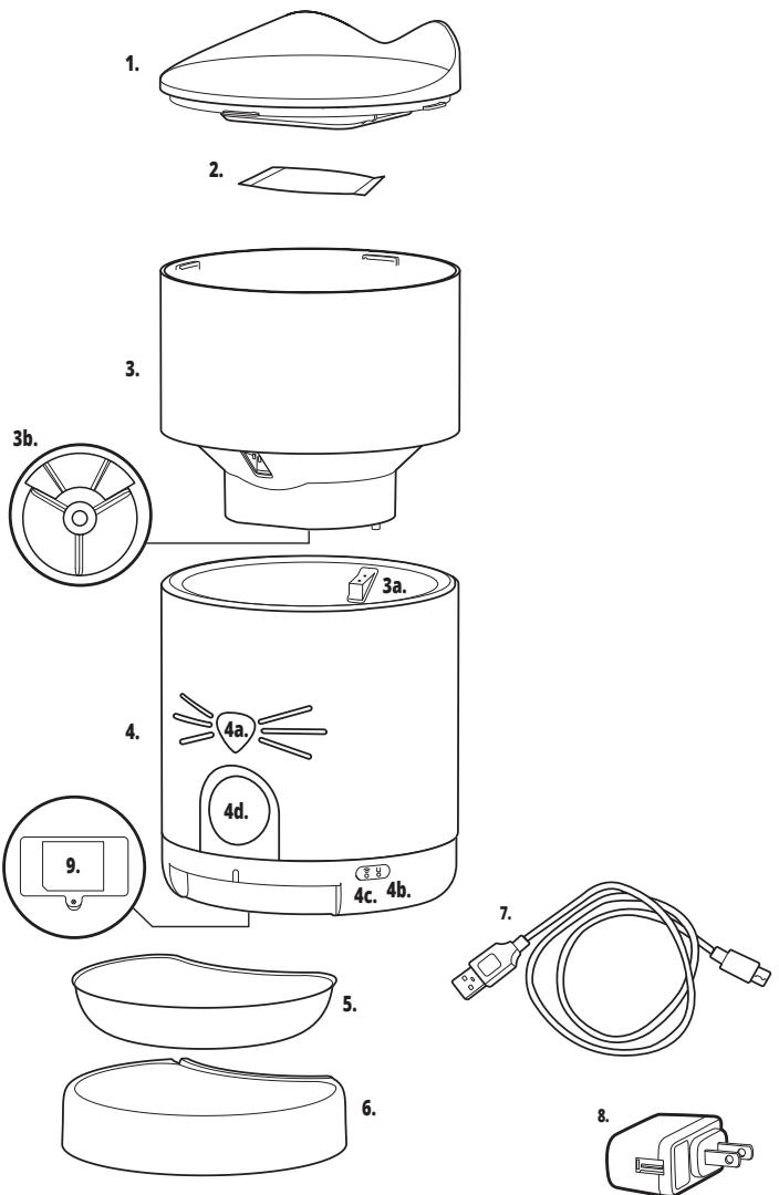
**1. Feeder lid / Couvercle du distributeur / Abdeckung des Futterautomaten / Tapa del comedero / Tampa do comedouro / Deksel / Pokrywka karmidla / Etető fedele / Copercchio dispenser / Foderautomatlåg / Крышка корумшки / Automatens lock / víko krmitka / Capac hránitor / Automaatin kanssi**
