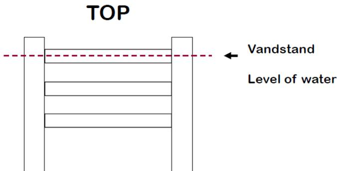
Man ska fylla på vatten (med ett innehåll av 10% av Glykol om frysrisk finns) innan man monterar radiatoren ordentligt på väggen då man behöver vända och vrida på radiatoren för att vattnet ska fördela sig i alla rör i radiatoren, annars finns det risk att det inte kommer in vatten i alla rör.
