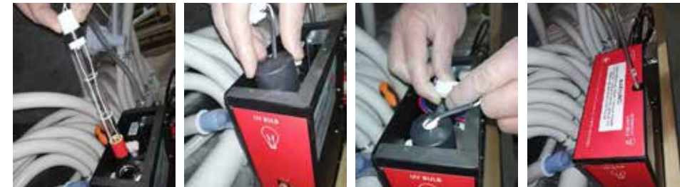
5. Schritt: UV Licht zum Wechseln rausnehmen
