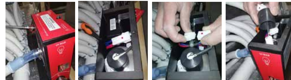
1. Schritt: Lösen Sie die 2 rot markierten Schrauben.
