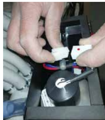
3. Schritt: Weisse Verbindungsstücke entkuppeln
