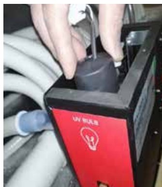
6. Schritt: Neues UV Licht in die Metallröhre stecken und schwarze Abdeckung wieder platzieren
