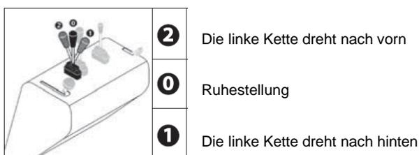
Linker Fahrhebel: Der linke Fahrhebel steuert die linke Kette.
