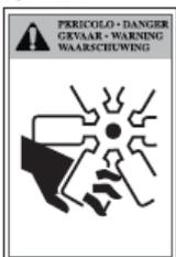
Weist auf eine potenzielle Gefahr hin, da die Möglichkeit eines Kontakts mit sich bewegenden mechanischen Teilen besteht, was schwere Verletzungen nach sich ziehen kann.
