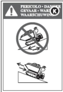
Das Schild zeigt an, wie an Steigungen und Gefällen vorzugehen ist, um schwerwiegende Folgen für den Bediener der Maschine zu vermeiden, da eine potenzielle Kippgefahr besteht.
