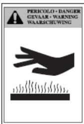
Mahnt zur Vorsicht, da durch die Nähe zu heißen Oberflächen eine Verbrennungsgefahr besteht.
