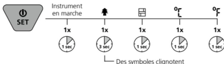
**!** L'appareil commence avec le dernier mode de mesure choisi. Pour sélectionner le mode, appuyer sur la touche de réglage Set pendant 3 secondes ou attendre un peu jusqu'à ce que le symbole ne clignote plus.
