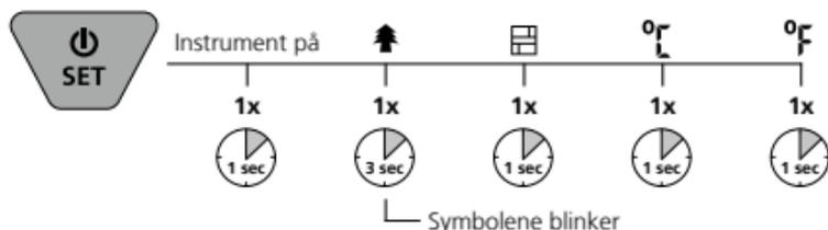
Instrumentet starter med den målemodus som sist var valgt. Til valg av modus trykkes Set-knappen i 3 sekunder, eller vent til symbolet ikke blinker mer.
