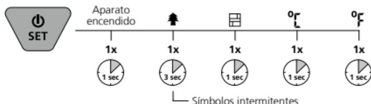
**!** El aparato se inicia con el último modo de medición seleccionado. Para seleccionar el modo pulse la tecla Set durante 3 segundos o espere un momento hasta que deje de parpadear el símbolo.
