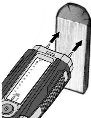
De te meten plek dient onbehandeld en vrij van takken, verontreinigingen of hars te zijn. Er dient géén meting aan de kopse zijden te worden uitgevoerd omdat het hout hier bijzonder snel droogt, hetgeen zou leiden tot vervalste meetresultaten.
