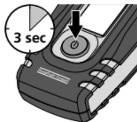
Na het inschakelen van het apparaat wordt op het display gedurende 3 seconden de omgevingstemperatuur weergegeven.
