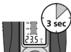
Al encender el aparato se visualiza en la pantalla la temperatura ambiente durante 3 segundos.
