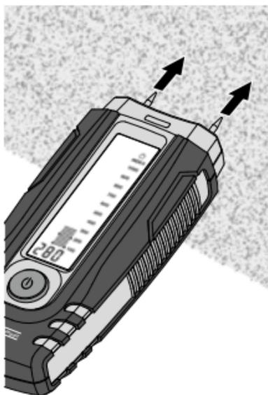
Tenga en cuenta que las paredes (superficies) compuestas de diferentes materiales, o con materiales de composición mixta pueden falsificar los resultados de medición.
