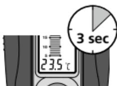
Po włączeniu urządzenia na wyświetlaczu przez 3 sekundy wyświetla się temperatura otoczenia.
