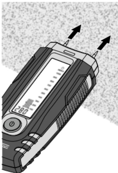
Es ist zu beachten, dass bei Wänden (Flächen) mit unterschiedlicher Materialanordnung, oder aber auch die unterschiedliche Zusammensetzung der Baustoffe, die Messergebnisse verfälschen können. **Führen Sie mehrere Vergleichsmessungen durch.**
