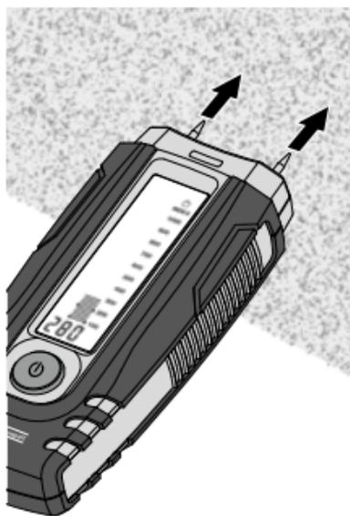
Tenir compte du fait que des parois (surfaces) composées de différents matériaux ou encore que la composition différente des matériaux de construction peut(vent) fausser les résultats de mesure.
