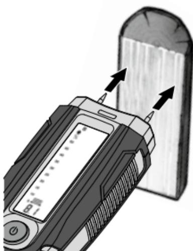
L'emplacement à mesurer doit être non traité et exempt de branches, de saletés ou de résine. Ne pas effectuer de mesure sur les surfaces d'attaque étant donné que le bois sèche particulièrement vite à cet endroit et que cela pourrait fausser les résultats de mesure. **Réaliser plusieurs mesures comparatives perpendiculairement aux veines du bois.**
