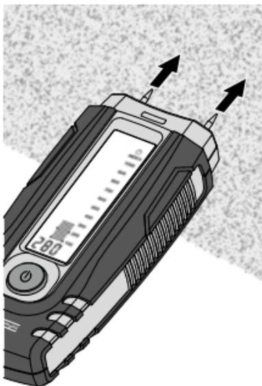
Man skal være opmærksom på, at vægge (overflader) med varierende materialefordeling og/eller med forskellig sammensætning af byggematerialer kan forårsage falske måleresultater. **Husk at udføre flere sammenligningsmålinger.**
