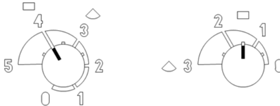
Abbildung 11 - linkseitig: Primärluftregler, rechtsseitig: Sekundärluftregler
