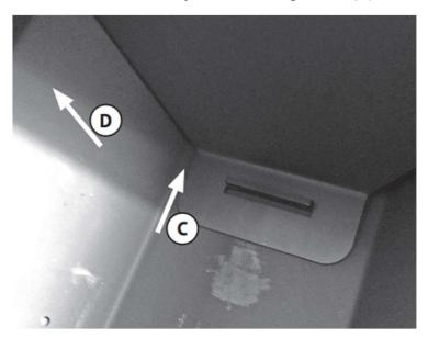
• Darüber ist eine 3. Heizgasumlenkung aus Blech angeordnet. Diese leicht anheben und nach hinten aus der Bajonetthalterung schieben.
