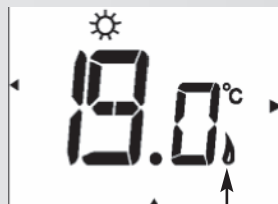
Heizanzeige des Heizkörpers
