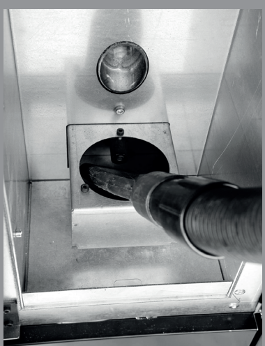
Abb. 5f: Reinigung des Brenntopfes
