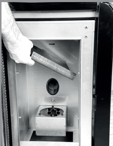
Abb. 5d: Flammschutz entfernen
