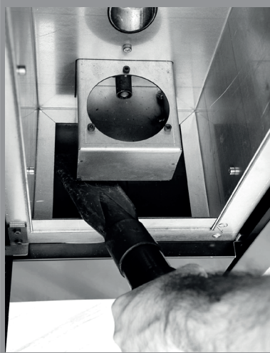
Abb. 5e: Reinigung des Aschekastens
