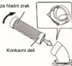
Kanal za hladni zrak
