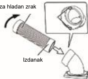
Kanal za hladan zrak
