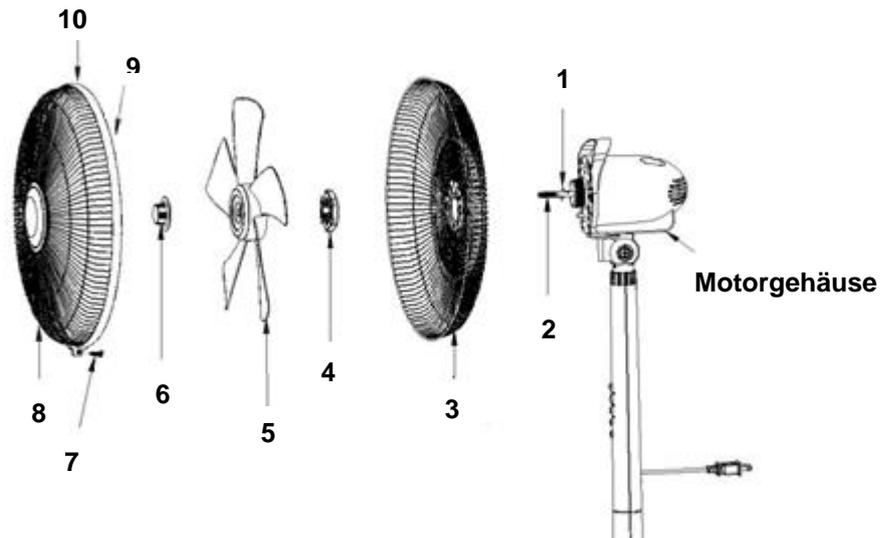
Montieren Sie die Rotorblattmutter (6) und die Gewindemutter (4) durch Drehen von der Motorwelle (2) ab.
