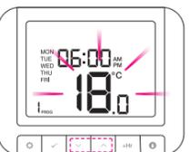
Mit HOCH oder RUNTER stellen Sie die Stunde ein, mit SELECT bestätigen. Mit HOCH oder RUNTER stellen Sie die Minuten ein, mit SELECT bestätigen. Mit HOCH oder RUNTER stellen Sie die Temperatur ein, mit SELECT bestätigen.
