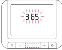
Drücken Sie SELECT. Mit HOCH oder RUNTER ON auswählen und mit SELECT bestätigen. Mit HOCH oder RUNTER den Wartungszeitraum (in Tagen) auswählen und mit SELECT bestätigen.
