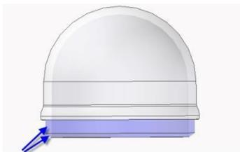
Vor dem Einsetzen eines neuen Aufsatzes muss das Gewinde mit Silikon geschmiert werden. Beim Auswechseln des Aufsatzes muss darauf geachtet werden, dass der Aufsatz bis zur letzten Windung aufgedreht wird. Andernfalls ist die Dichtheit des Kamerakopfes nicht gewährleistet und die Funktionsweise kann durch Eindringen von Wasser oder Verschmutzungen beeinträchtigt werden.
