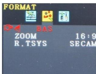
Im Untermenü „Format“ kann der Benutzer die Anzeige des Displays drehen, das Displayformat 16:9 auf 4:3 ändern oder das VideofORMAT auswählen.
