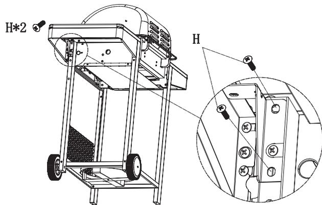
Die rechte Seitenablage (14) vorne mit Schrauben (H) befestigen.
