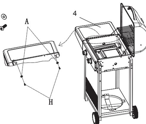
Die Seitenablage (4) links einhängen und mit Schrauben (H) und Unterlegscheiben (A) festschrauben.
