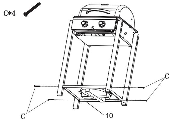
Die Bodenplatte (10) mit Schrauben (C) an die vorderen und hinteren Standbeinen (9A, 16A und 9B, 16B) schrauben.
