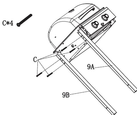
Die linken Standbeine (9A vorne, 9B hinten) und Brennergehäuse mit Deckel (3) mit Schrauben (C) verbinden.
