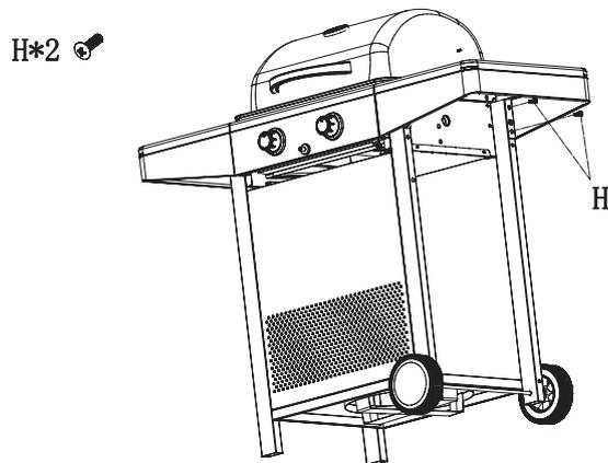
Die rechte Seitenablage (14) hinten mit Schrauben (H) befestigen. Alle Schrauben festziehen.
