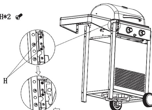
Zwei Schrauben (H) in die linke Seite der Bedienblende schrauben. Schrauben noch nicht festziehen.
