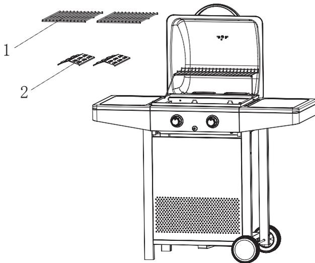
Die Grillroste (1) und die Flammverteilerplatten (2) im Brennergehäuse (3) platzieren.
