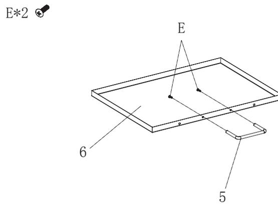
Den Griff (5) mit Schrauben (E) an der Auffangschale (6) befestigen.
