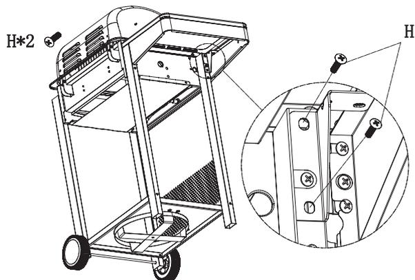
Die linke Seitenablage (4) vorne mit Schrauben (H) befestigen.
