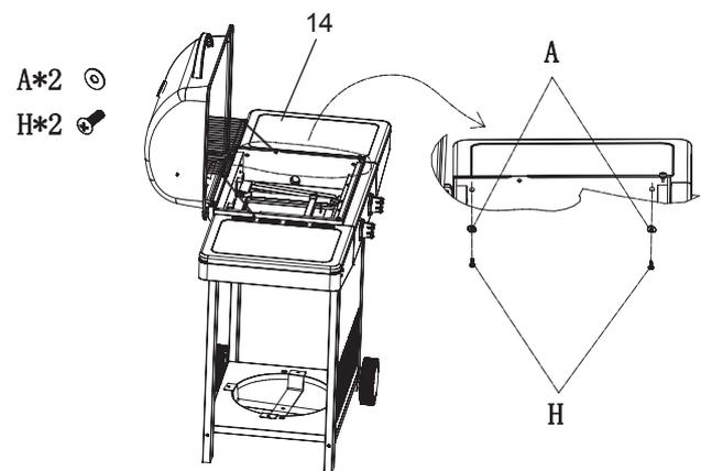
Die Seitenablage (14) rechts einhängen und mit Schrauben (H) und Unterlegscheiben (A) festschrauben.
