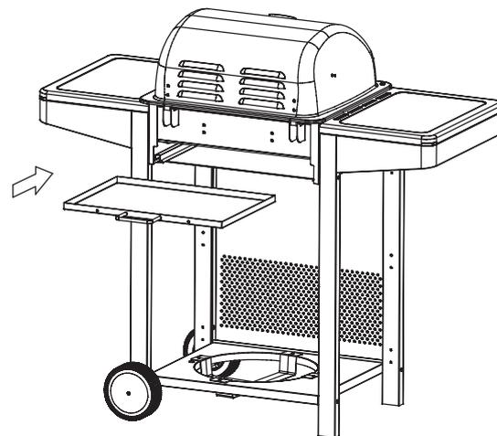
Die Auffangschale (6) von hinten unter das Brennergehäuse (3) schieben.
