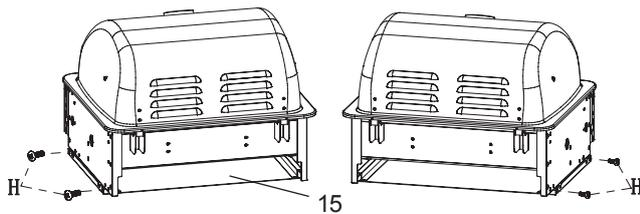
Schieben Sie das Hitzeschild (15) von hinten unter das Brennergehäuse und befestigen Sie es mit Schrauben (H).
