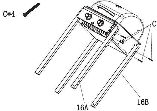
Die rechten Standbeine (16A vorne, 16B hinten) und Brennergehäuse mit Deckel (3) mit Schrauben (C) verbinden.
