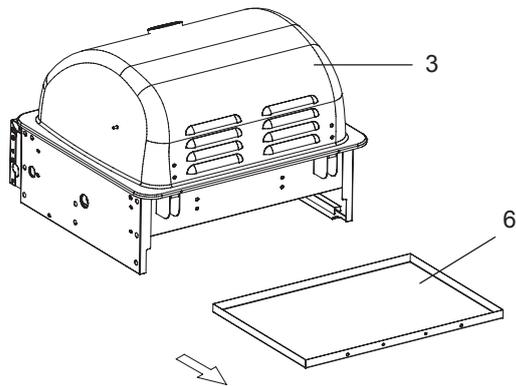
Entfernen Sie die von hinten unter das Brennergehäuse (3) eingeschobene Abtropfschale (6).
