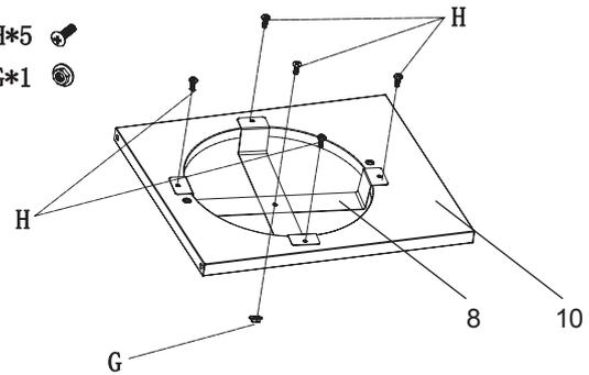
Die Gasflaschenträger (8) mit Schraube (H) und Kontermutter (G) verbinden und mit Schrauben (H) an die Bodenplatte (10) schrauben.
