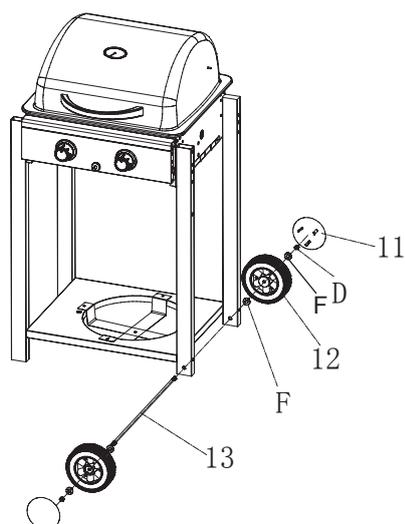
Die Radachse (13) durch die rechten Standbeine (16A, 16B) stecken und beidseitig mit Unterlegscheiben (F) bestücken. Räder (12) auf die Enden der Radachse schieben und mit Unterlegscheibe (F) und Mutter (D) sichern. Radkappen (11) auf die Räder (12) stecken.
