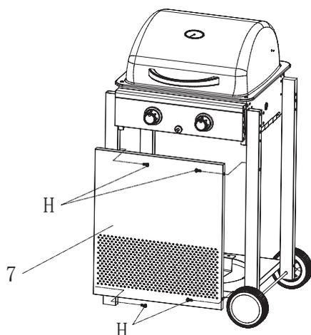
Die Frontverblendung (7) und die vorderen Standbeine (9A und 16A) mit Schrauben (H) verbinden.
