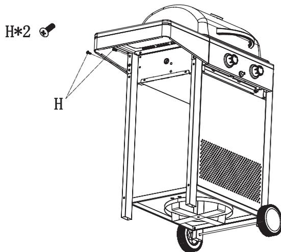
Die linke Seitenablage (4) hinten mit Schrauben (H) befestigen.
