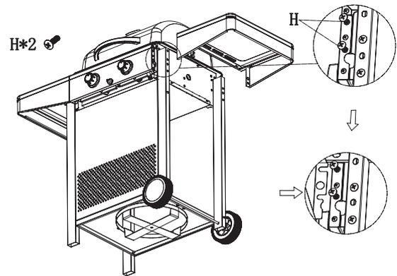
Zwei Schrauben (H) in die rechte Seite der Bedienblende schrauben.
