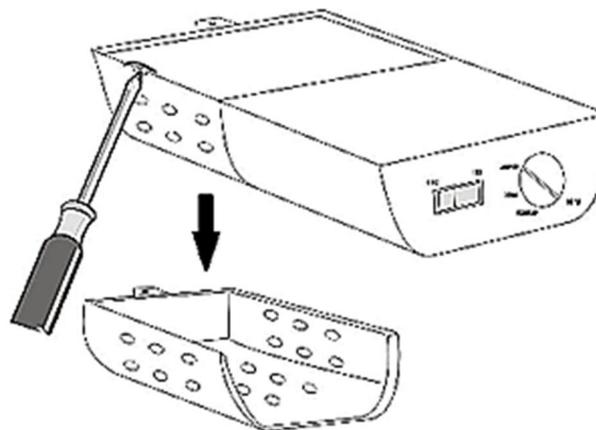
1. **Stellen Sie den Thermostat auf MIN und trennen Sie das Gerät von der Stromversorgung, bevor Sie das Leuchtmittel auswechseln.**
