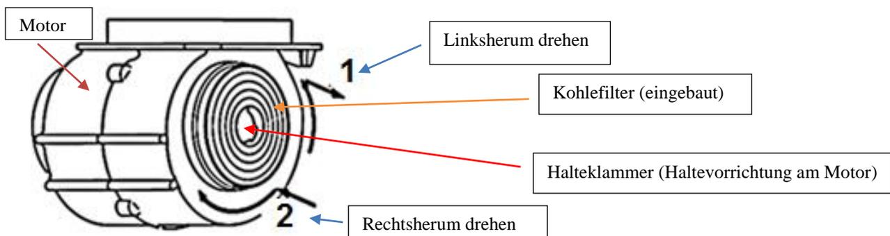
1. Nach links drehen = Der darauf befindliche Kohlefilter wird zum Entfernen nach links gedreht
