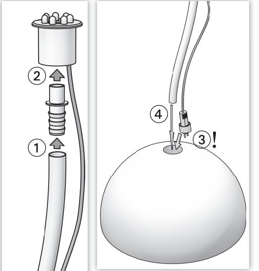
3 Platzieren Sie die Pumpe im Unterteil und führen Sie das Kabel von Pumpe und LED durch das Rohr im Unterteil nach außen. Verbinden Sie den Schlauch mit der Pumpe.
