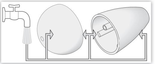
2 Verbinden Sie den Schlauch mit der LED und führen Sie den Schlauch und das LED-Kabel durch die Öffnung des Oberteils. Pressen Sie das LED mit leichtem Druck in die Öffnung des Oberteils.
