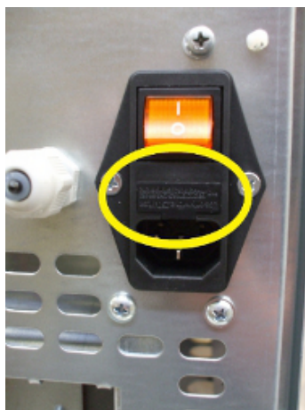
Fig. 88 - Abdeckklappe mit Sicherungen, die ausgewechselt werden müssen
