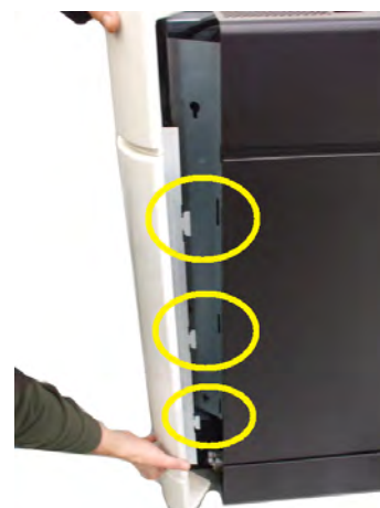
Fig. 27 - Befestigung am Ofen
