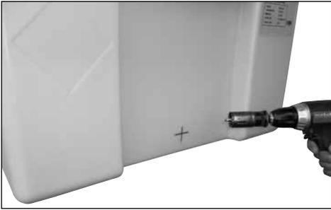
Draht von Auslaufbohrung zur Einfüllöffnung einziehen.
