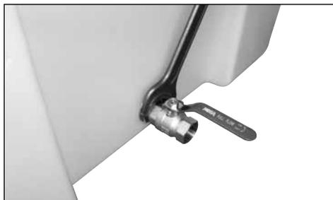
Auslaufhahn durch die Mutter am Einschraubgewinde senkrecht ausrichten.
