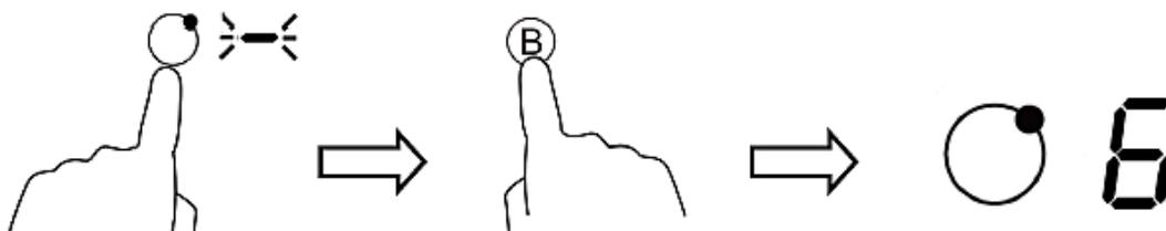
5. Alle Kochzonen können separat mit der beschleunigten Aufheizfunktion betrieben werden. Wenn Sie die beschleunigte Aufheizfunktion verwenden, schalten Sie bitte vorher eine andere so verwendete Kochzone innerhalb derselben Gruppe ab (s.a. Abb. Kap. 3.8); anderenfalls werden p und 9 auf der Anzeige der gewählten Kochzone alternierend blinken und die Leistungsstärke 9 wird automatisch eingestellt.
