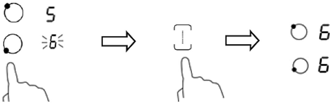
3. Wählen Sie einen der beiden EINSTELLUNG DER LEISTUNGSSTÄRKE-Sensoren zur Regulierung der Leistungsstärke der flexiblen Kochzone aus.
