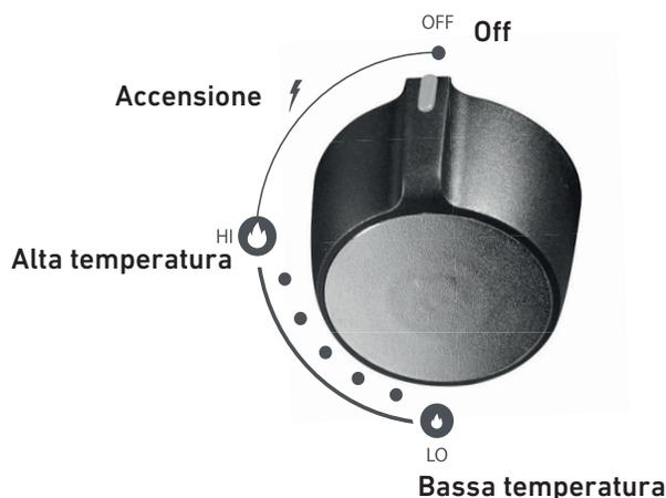
Ogni bruciatore tubolare è controllato da una manopola di regolazione. Ogni manopola di regolazione dispone di una barra rossa che indica la sua impostazione. Dopo l'accensione di un bruciatore la temperatura può essere regolata portando la manopola di regolazione in una posizione tra HI / temperatura alta e LO / temperatura bassa.
