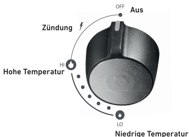
Jeder Rohrbrenner wird mit einem Bedienknopf bedient. Jeder Bedienknopf ist mit einem roten Balken versehen, um die Stellung des Knopfes anzuzeigen. Nachdem ein Brenner gezündet worden ist, kann die Temperatur nach Bedarf mit dem Bedienknopf zwischen **HI** / Hohe Temperatur und **LO** / Niedrige Temperatur eingestellt werden.
