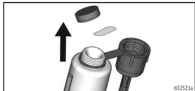
3. Bei Bedarf Einlasssieb vom Saugrohr schrauben. Entlüftungs-/Spritzventil auf ANSAUGEN-Position stellen.
