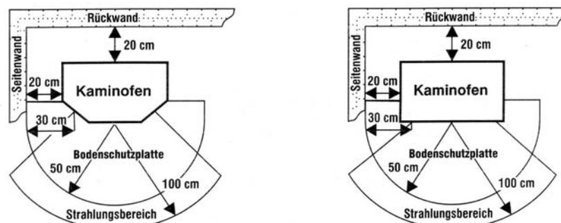
Wenn eine Feuerstätte ohne Abstand zu brennbaren / temperaturempfindlichen Materialien aufgestellt werden kann, ist dies im technischen Datenblatt und auf dem Typenschild vermerkt.
