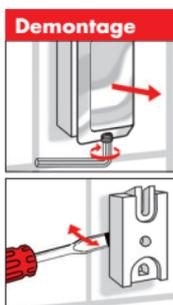
Adapter mittels Schraubenzieher/ Spachtel anheben (Tipp: Adapter vorher mit Haartrockner anwärmen)
