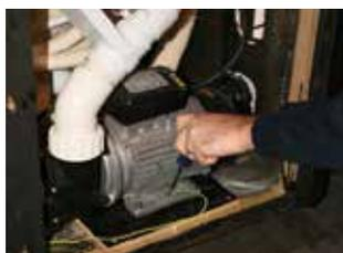
**7. Schritt:** Schrauben Sie die Masseleitung von der Pumpe ab (sorgen Sie dafür, dass die Leitung gefahrlos aus dem Umkreis der Pumpe entfernt wird).
