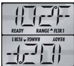
Ermöglicht es die digitale Anzeige um 180° zu drehen
