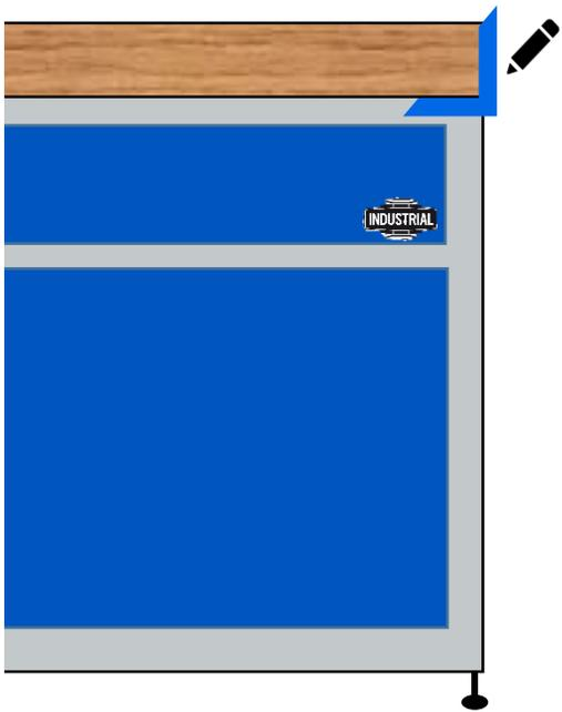
1. Holzplatte abschrauben. / Unscrew the wooden plate.
