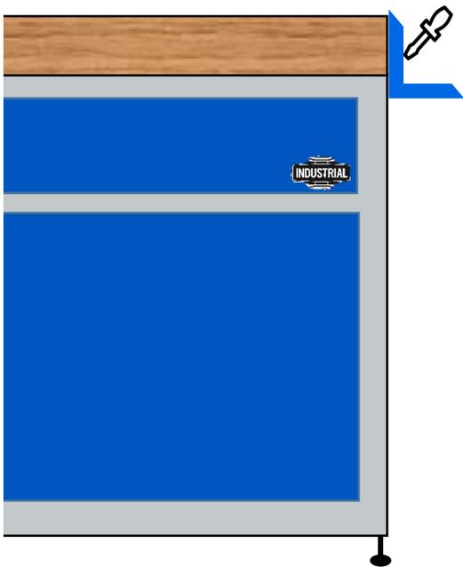
4. Den Winkel umdrehen und an der Werkbankplatte anschrauben. / Turn the square over and screw it onto the workbench plate.
