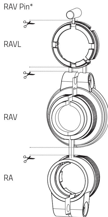
\* Bei Verwendung des RAV-Adapters benötigen Sie den RAV Pin zur Verlängerung des Ventilstößels.
