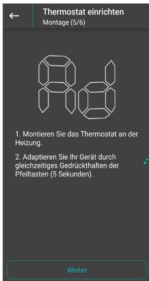
Montieren Sie nun Ihr Thermostat am Heizkörper und starten Sie nach erfolgreicher Montage die Adaptierung. Halten Sie dafür die beiden Pfeiltasten am Comet WiFi gleichzeitig für 5 Sekunden gedrückt.
