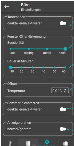
Durch das Aktivieren der Tastensperre wird die manuelle Bedienung am Regler gesperrt.
