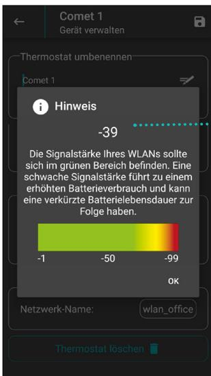
Bitte beachten Sie, dass sich die Signalstärke Ihres WLANs im grünen Bereich befinden sollte. Eine schwache WLAN-Signalstärke kann zu einem erhöhten Batterieverbrauch Ihres Comet WiFi führen und damit eine verkürzte Batterielebensdauer zur Folge haben. Außerdem kann eine niedrige Signalstärke zu Kommunikationsproblemen führen.
