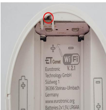
HINWEIS: Um an den tiefer liegenden Taster im Batteriefach zu gelangen, verwenden Sie das mitgelieferte kleine Werkzeug oder einen ähnlich dünnen Gegenstand (z.B. Büroklammer).
